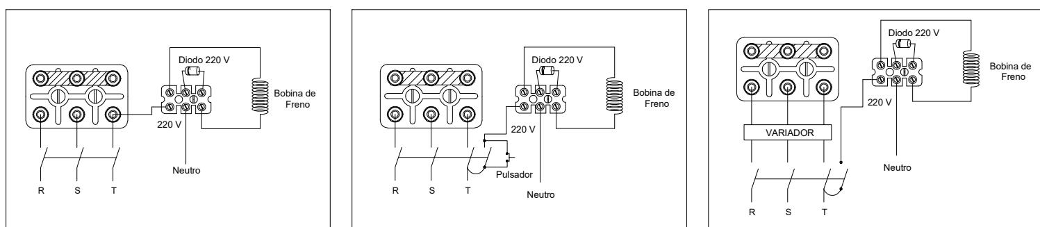
**FRENADO INSTANTANEO:** Se conecta una alimentación de la bobina del freno directamente al neutro.
