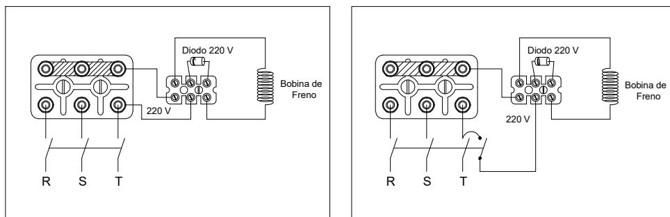
**FRENADO LENTO:** Se alimenta el diodo directamente de los terminales del motor.
