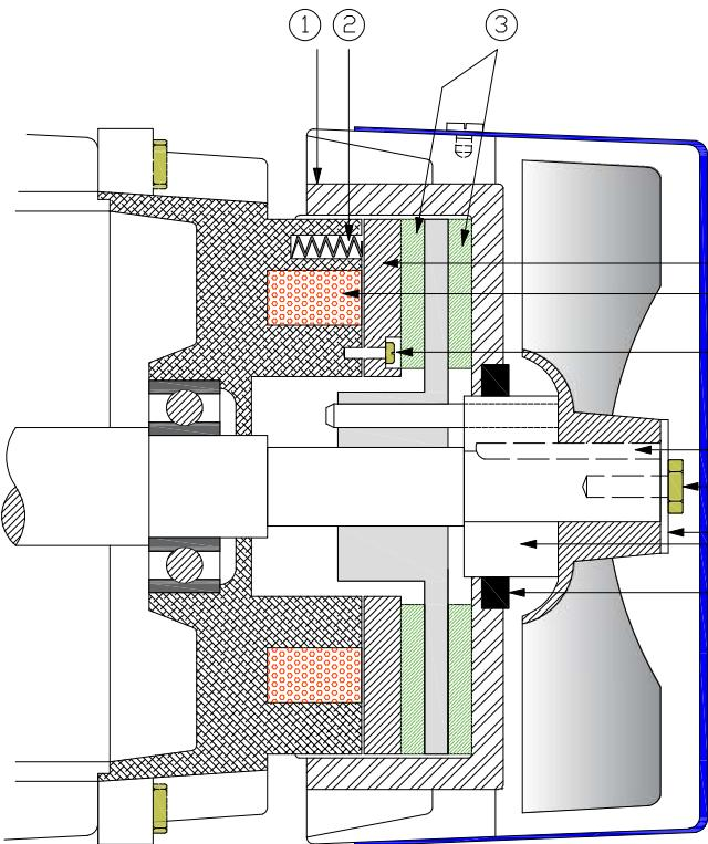
1.- Tapa roscada para ajuste de la luz libre del disco de freno. Se actúa sobre éste cuando por desgaste del material antideslizante actúan los topes (5), esto lo indica la reducción del frenado, se quitan las trabas, se gira afondo de luz cero y se coloca nuevamente la traba y el cubreventilador.
